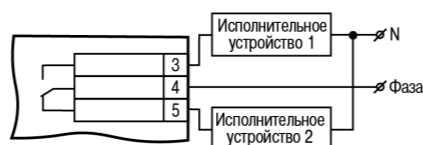
Рисунок 15 – Схема подключения нагрузки к ВУ типа P
