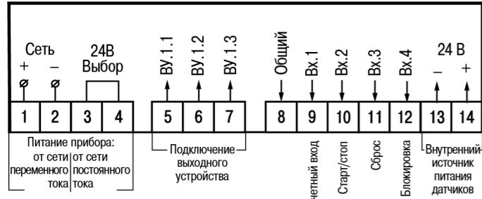
Рисунок 9 – Назначение контактов клеммника
