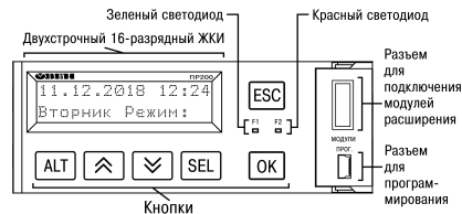
Рисунок 10 – Лицевая панель прибора (крышка отсека подключения модулей условно не показана)
