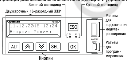
Рисунок 7 – Лицевая панель прибора (крышка отсека подключения модулей условно не показана)
