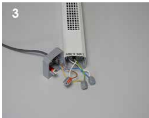
Шаг 3. Подключить провод P-N-PE к клеммам
