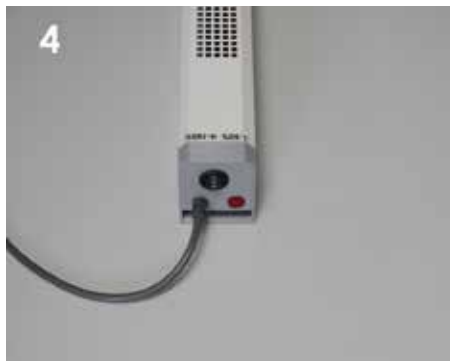
Шаг 4. Вставить торцевую заглушку в корпус и установить фиксатор кабеля на сетевом шнуре.
