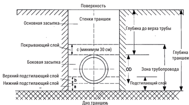
РИС. 3. УСТРОЙСТВО ТРАНШЕИ
