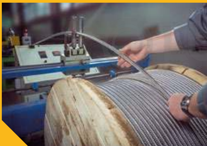
Подача гофрированной трубы Stahlmann для отжига
