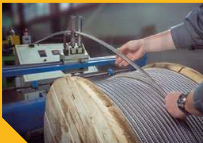
Подача гофрированной трубы Stahlmann для отжига
