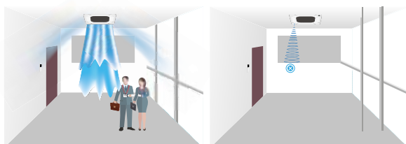
Внутренний блок автоматически включается при обнаружении человека
