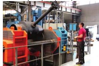
Тестирование шаровых кранов
