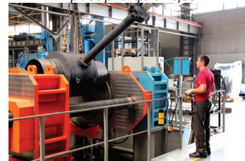
Тестирование шаровых кранов
