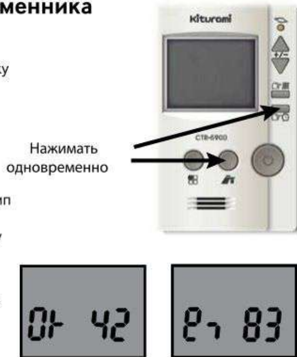
Рисунок 16. Настройка типа теплообменника
