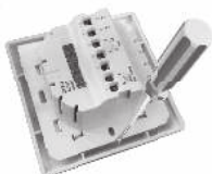
Рисунок 5. Демонтаж лицевой панели
