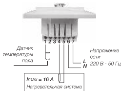
Рисунок 4. Схема подключения к терморегулятору
