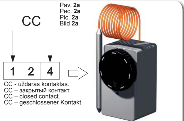
Prieššaliminio termostato patikrinimas. Проверка противозаморающего термостата. Inspection of the antifreeze thermostat. Überprüfung des frostbeständigen Thermostates.
