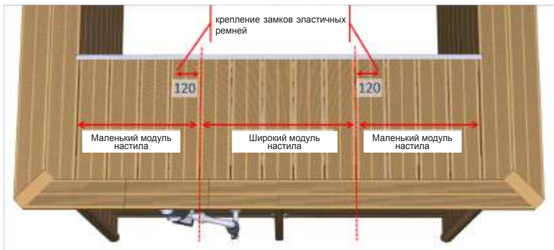
Рисунок 53 – Крепление эластичных ремней под решетками
