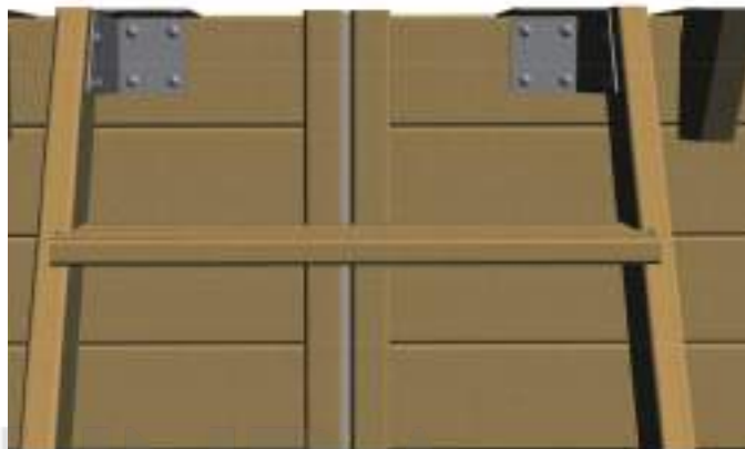
Figure 16 – Крепление лестницы с наружной стороны бассейна
