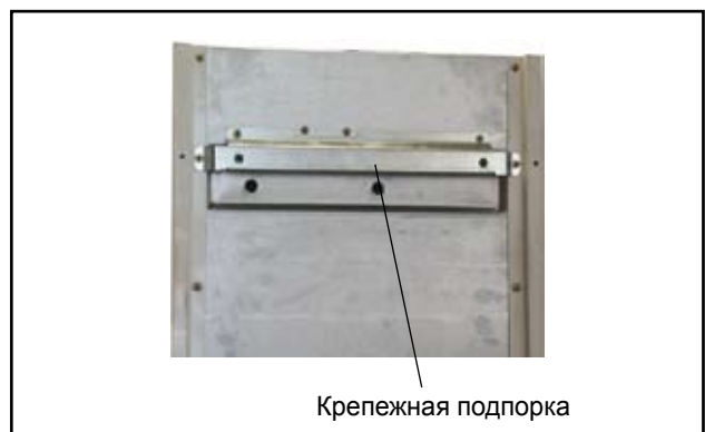
Рис.: Подпорка на газовом настенном котле
