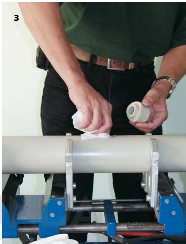
3 Вварное седло надеть на насадку так, чтобы были совмещены метки на седле и насадке. Прогреть отверстие и ввариваемое седло. Время прогрева как у трубы диаметром 32 мм – 8 с. Для вварных седел 110 x 32 и 110 x 40 время нагрева такое же, как для диаметра 40 мм – 12 сек.
