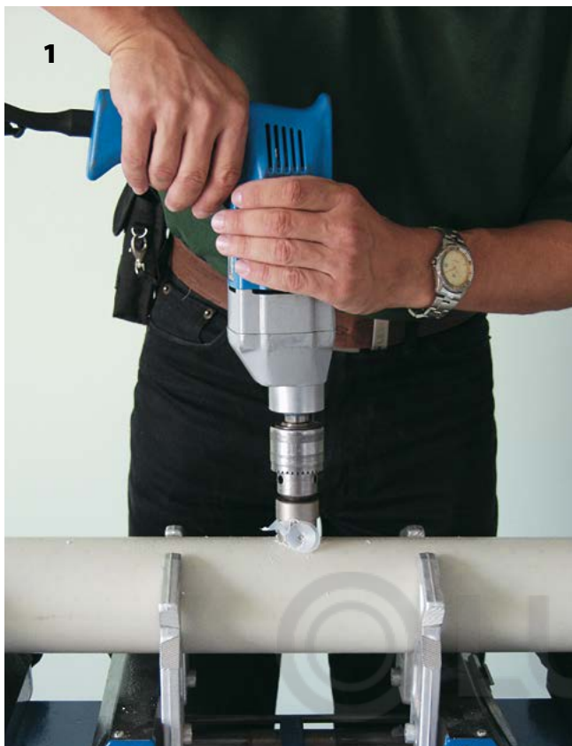
1 Специальной фрезой высверлить отверстие для седла
