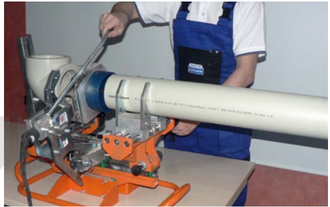
закрепление в аппарате и центровка, потом нагрев
