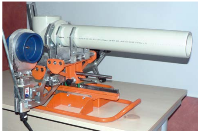
готовое сварное соединение после охлаждения
