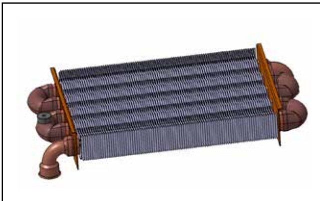
Рис.: Теплообменник нагрева воды (9)
