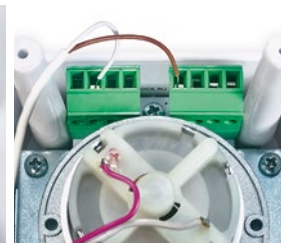
Фото 11. Подключение датчика к электроприводу
