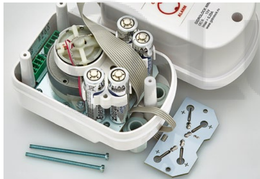
Фото 31. Контактная площадка снята, батарейки могут быть заменены
