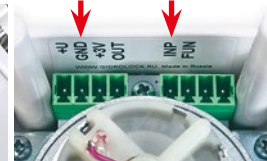
Фото 13. Клеммы подключения проводных датчиков — INP, GND
