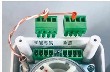
Фото 23. Подключение проводного выключателя
