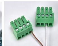
Фото 14. Подключение провода датчика к ответной части разъема
