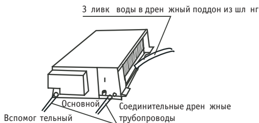
Рис. 7.4. Проверка слива конденсат
