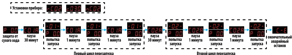
Графическое представление работы режима перезапуска "rC.02"
