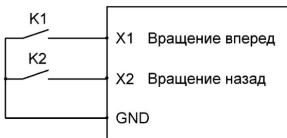
Рис. 5-11 Принципиальная схема двухпроводного режима работы
