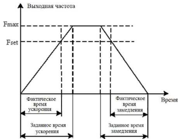
Рис. 6-2 Схема времени ускорения/замедления
