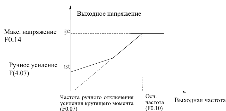
Рис.6-10 Схема усиления крутящего момента
