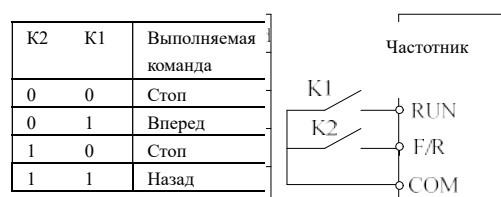
Рис. 6-14 Двухпроводной режим управления 2
