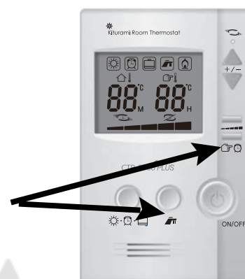
Рисунок 8. Настройка типа теплообменника
