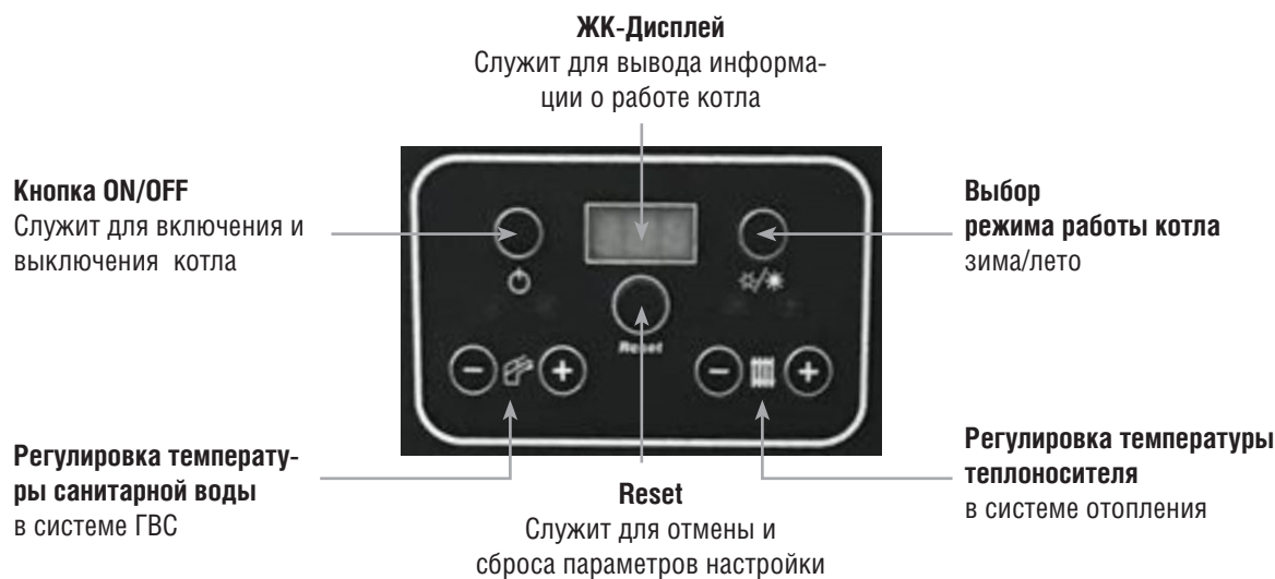
Рис. 6 Панель управления котла Kobold S
