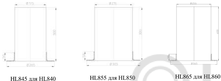
Рис. 2. Закладные элементы для противопожарных муфт.
