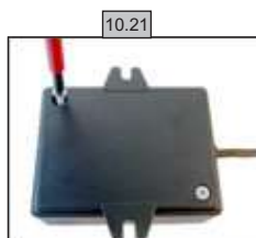
10.21 Снимите основание модуля Wi-Fi.
