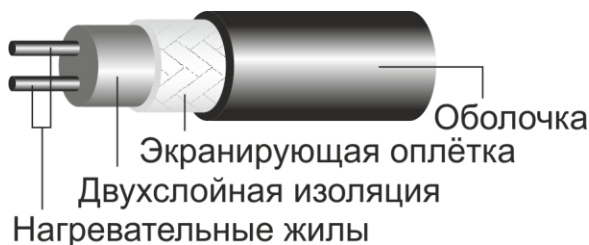
Рисунок 3 - Устройство нагревательного провода.
