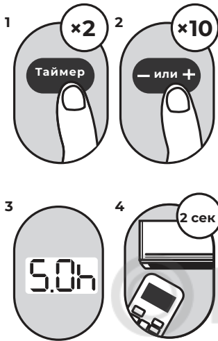
Пример: установка таймера на отключение блока через 5 часов.
