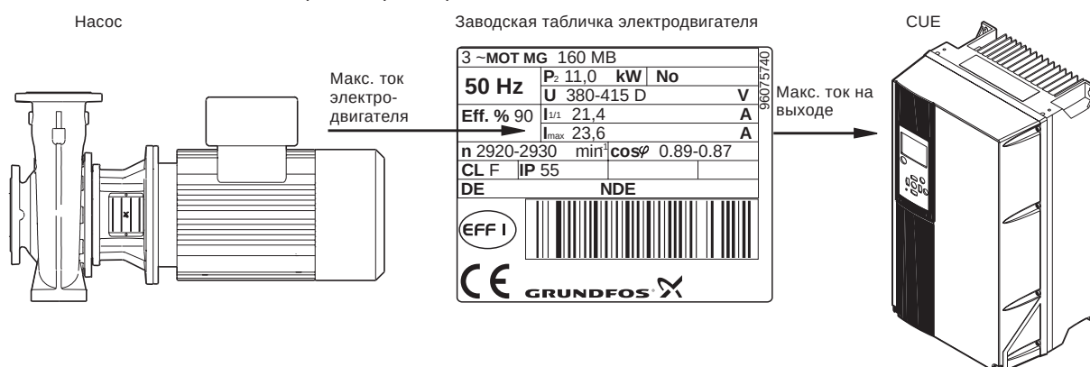
Рис. 134 Подбор CUE на основании максимального тока электродвигателя.
