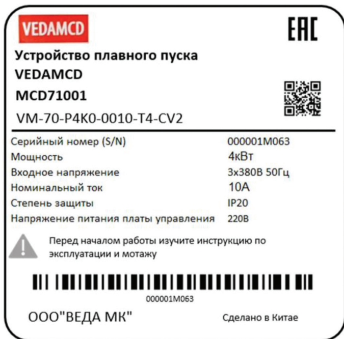
Рисунок 1. Пример маркировки устройства плавного пуска
