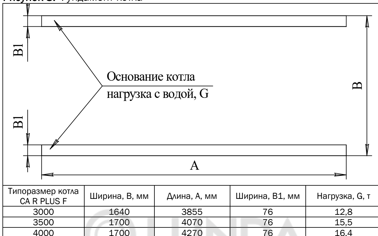
Рисунок 8. Фундамент котла
