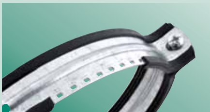
резиновая изоляция заплавлена в перфорацию хомута
