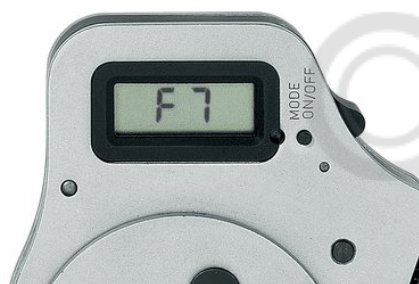
Мультифункциональный дисплей, настройка в мм, дюймах или сравнимые позиции для выбора согласно MIL
