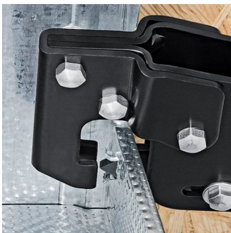
Пуансон инструмента продавливается через профили
