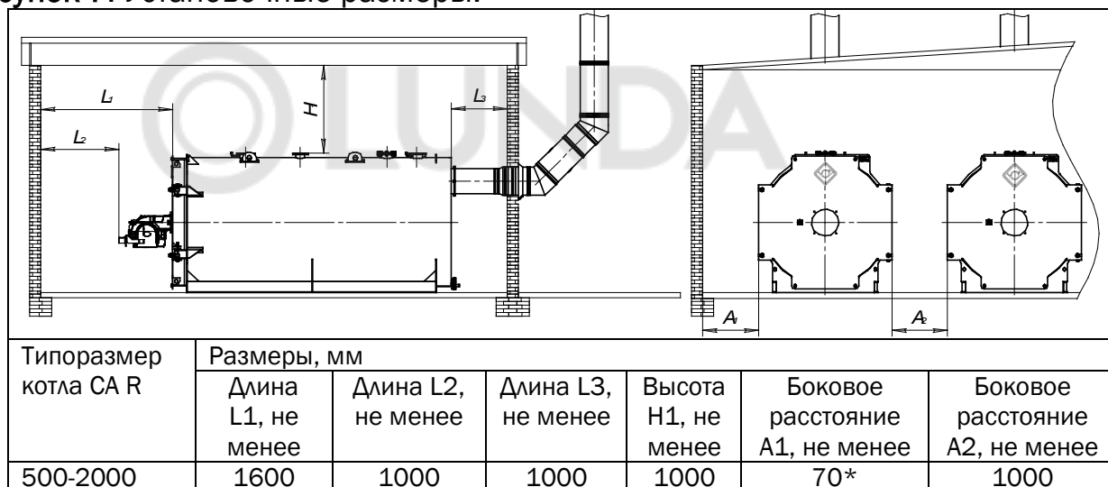
Рисунок 7. Установочные размеры.
