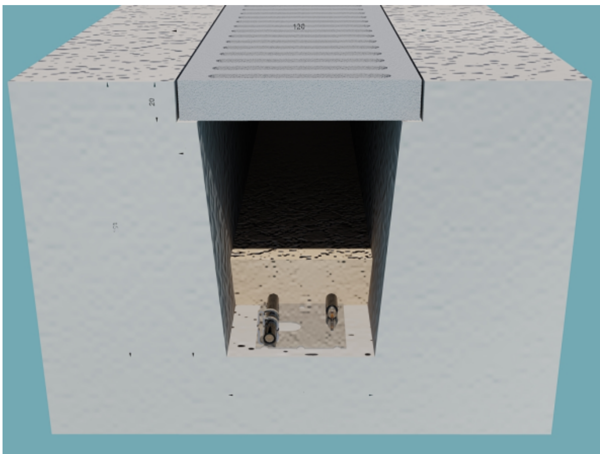
Скрытый обогрев дренажного водоотводного наземного лотка с защитной чугунной решёткой:
