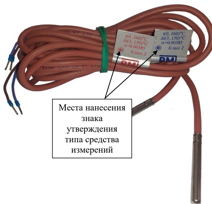
Рисунок 3 – Места нанесения знака утверждения типа средств измерений
