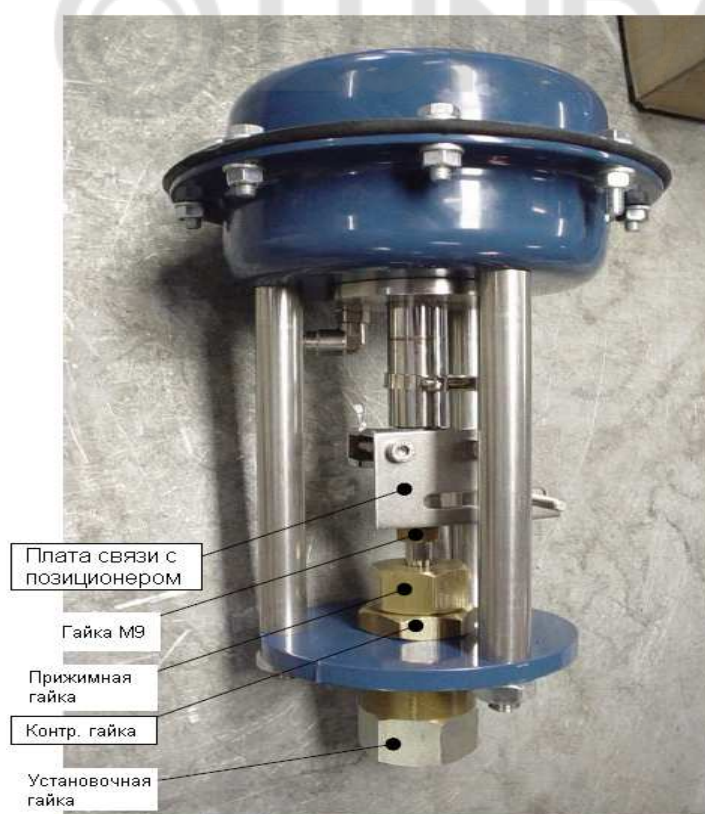
Рис. 2. Пневмопривод с платой связи позиционера.
